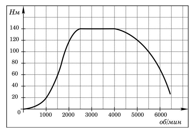
На графике изображена зависимость крутящего момента автомобильного двигателя от числа его оборотов в минуту. На оси абсцисс откладывается число оборотов в минуту. На оси ординат — крутящий момент в Н · м. Чтобы автомобиль начал движение, крутящий момент должен быть не менее 60 Н · м. Какое наименьшее число оборотов двигателя в минуту достаточно, чтобы автомобиль начал движение?
